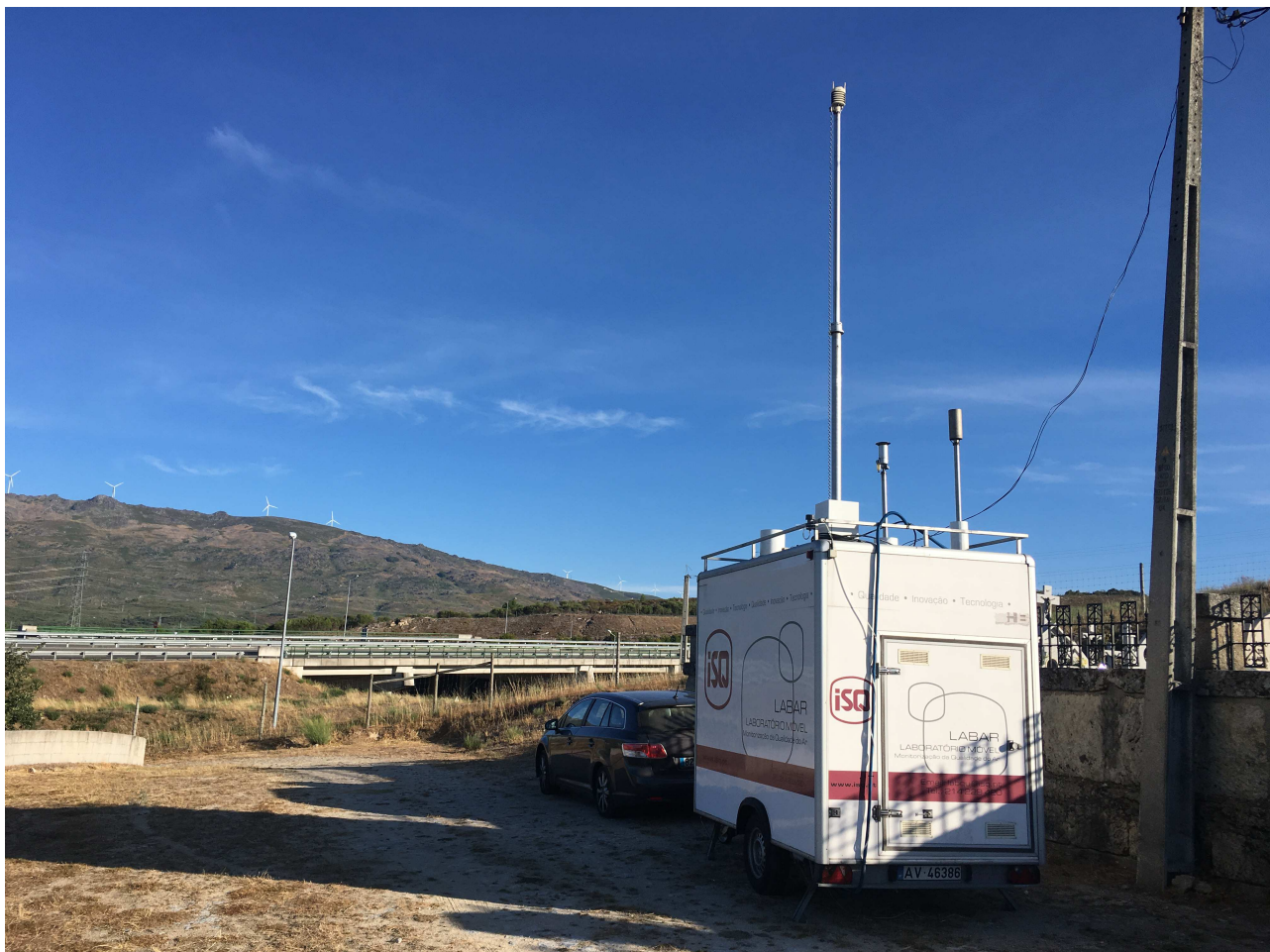
Figura 3 – Perspetiva da estação móvel de qualidade do ar durante as medições realizadas no local de medição P1.
